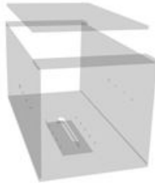
Figura 2.9: Zona de medida del túnel de viento
