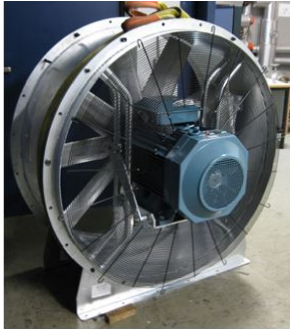
Figura 2.13: Ventilador del túnel de viento
