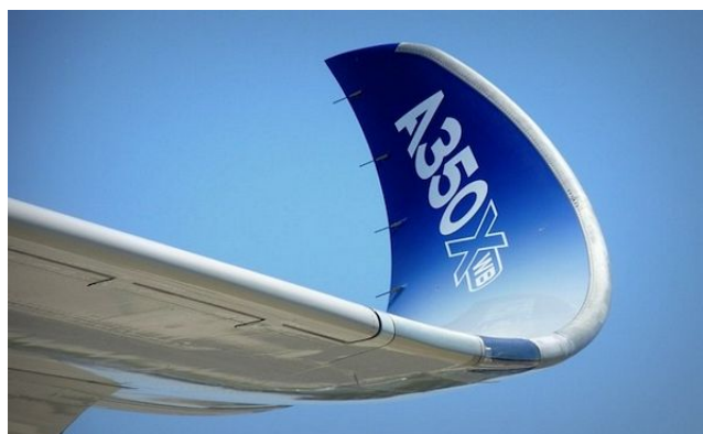
Figura 6.2: Winglet del ala de un Airbus A350 XWB
