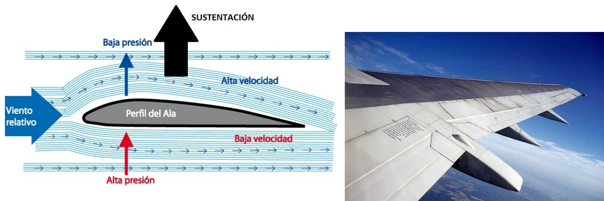
Figura 1.1: Flujo de aire en un perfil alar y ala de una aeronave.
